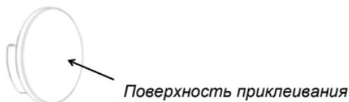
2. Приклейте держатель контейнера на относительно вертикальную плоскость блока инструментов
